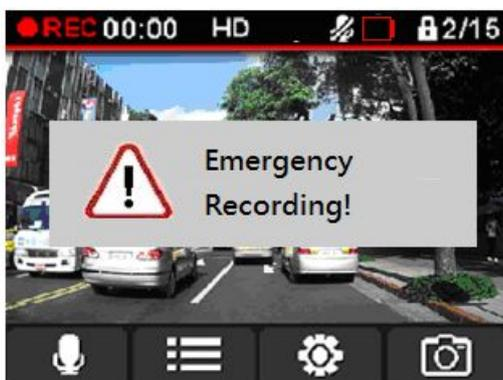
**Registrazione G-Sensor:** Durante la registrazione, la DrivePro attiverà automaticamente la registrazione d’emergenza quando rileverà una collisione.
